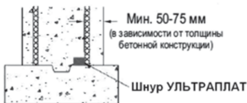
Установка шнура «УЛЬТРАПЛАТ» на сопрягаемых фундаментных конструкциях
